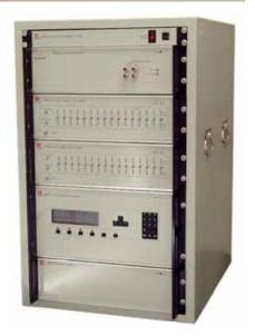
作業負荷の幅広い要求に合わせ、6625Aシステムは柔軟な構成をとる事ができます。6625Aは3000Aで  $0.1\,\mu$  から1000Vで1G まで、全て一つの6622A DCCブリッジで抵抗値を測定する事ができます。 Guildlineの6520 Digital Teraohmmeterを加えれば、何と10ペタ まで測定が可能になります。
