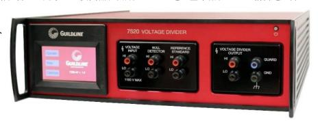
7520 の使用及び自己校正/自己調整時のサーマルオフセットとノイズを最小にする為の特別な工夫が施されています。電 圧基準と抵抗電圧分圧ネットワークは全て温度制御されたチャンバー内に収まっています。高絶縁リレーには超低サーマ ルスイッチが使用されています。更に、新しく設計された光学ヌル検出器の採用は、自己調整処理時の高絶縁性と低ノイ ズを保証します。
