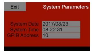
自動的なテストと校正を可能にする為に、7520 はイーサネット/IEEE 488.2 バスあるいは USB インターフェイス経由で制御可能です。更に、内蔵のマイクロプロセッサー、フロントパネルカラーのタッチスクリーンにより、手動による完全な操作もできます。
