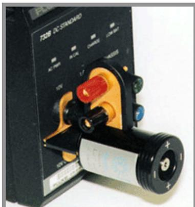
モデル98113 ロー・サーマル・リバーシング・スイッチは、広く一般的に使用されているツェナ DC ボルテージ・リファレンス・スタンダードの出力ターミナルに直接取り付けられるように設計された使い易い機器です。この設計がツェナ・リファレンス・ターミナルとスイッチの接点の間の熱平衡 (thermal equilibrium) を確実とします。このロー・サーマル・リバーシングの働きにより、フォワード・アンド・リバーサル計測の平均値が限りなくツェナ・リファレンス・ボルテージの正確な計測値になることを確実とします。この精度の理由で、モデル98113 ロー・サーマル・リバーシング・スイッチはNCSLIによるジョセフソン・ボルテージ・スタンダード比較試験に使用されています。
