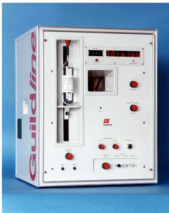
8400B “オートサル” 研究室用塩分計は、ギルドライン社が生産する製品の内最も新しい装置です。8400 シリーズは、塩分測定の産業標準になっています。この塩分計は、ユニークなフローシステムを採用しており、試料は、採集ビンより減圧にて吸込まれます。高い安定性の恒温槽と熱交換器は、分析中試料を指定した温度に保持します。その間温度補正は、必要としません。恒温槽の温度安定度の向上によって 0.002PSU 等量以上の精度を達成しました。独特の試料連続フローシステムは、通常の場合の塩分測定の際、必要な測定と洗浄の繰り返し作業を著しく迅速化し、簡略化しています。
