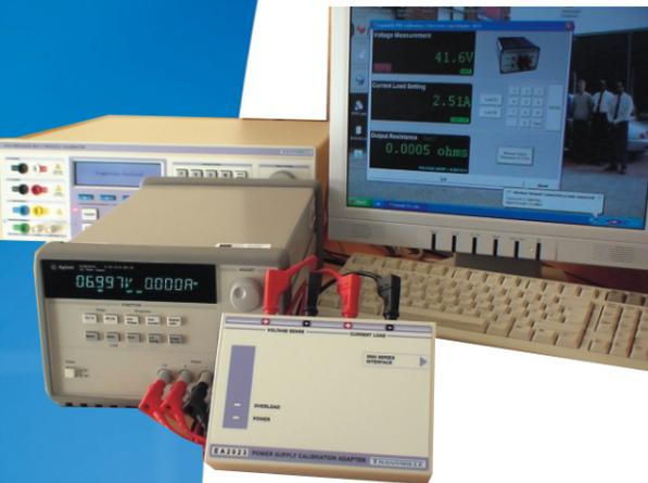
パワーサプライの校正を簡単にする必須のオプションです。PSUアダプターで出力電圧の測定ができ、精密電子電流負荷を備えているので、電圧、電流と更に出力抵抗をコンパクトな一つの装置で校正する事ができます。4端子接続なので正確さとリピータビリティも確かです。
