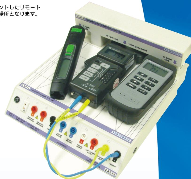
高度なクランプコイル、サーモカップルシミュレーション、タコメータ校正アダプター、圧力コントロールソース/測定機能を組み込んでいるのでワークステーションアダプターは、幅広い装置の多用途で効率的な校正プラットフォームとなります。
