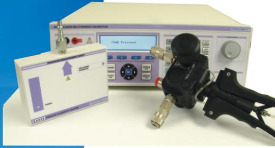
3041と3010は、校正器に直接接続する17のレンジの圧力モジュールを使用して、圧力校正をサポートします。圧力モジュールのレンジは25mバールから10000バールに及びます。5psiの差動モジュールと±1バール真空モジュールも利用できます。オプションとして手動圧力/真空ポンプがあり、60バールまでの空気圧と、-0.95バールまでの真空を作り出せます。
