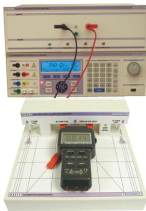
巻線AC & マグネティックフィールドホール効果 AC/DC クランプメータの両方の校正用に設計されたトランスミル社の電流コイルは、頑丈な作りで使用が容易なアライメントテーブルが備わっているなど幾つかのユニークな特色をもっています。
