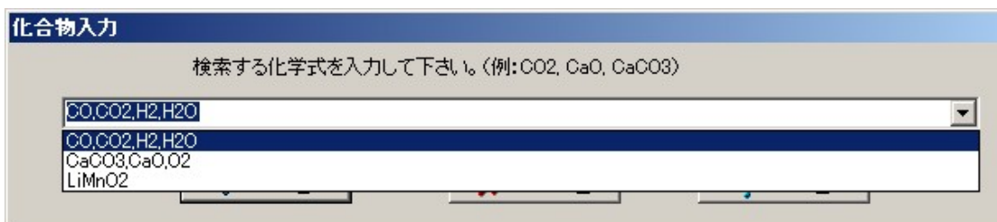
図 4.2 化合物毎に検索するために化合物入力フォーム：入力されたテキストはコンボボックスに格納され、右のプルダウンボタンをクリックすると表示される。
