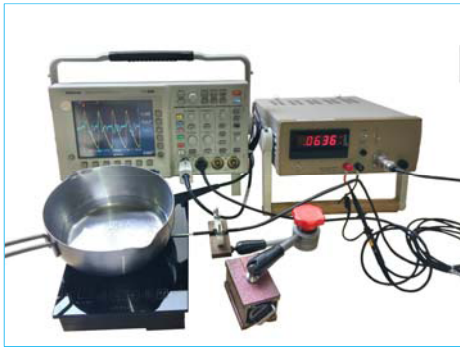
測定例: 電磁調理器の漏れ磁場測定
